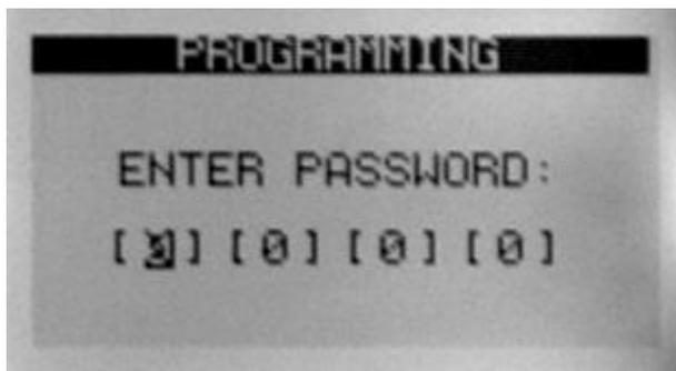
4-значный пароль должен быть введен с помощью кнопок ▼, ▲, ▶ и ◀.
